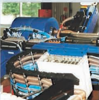
Überholung und Modernisierung einer Bohr-, Senk- und Nietanlage
