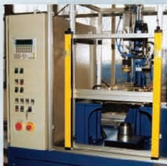
Sondermaschine zur Montage und Prüfung von Luftfedersystemen
