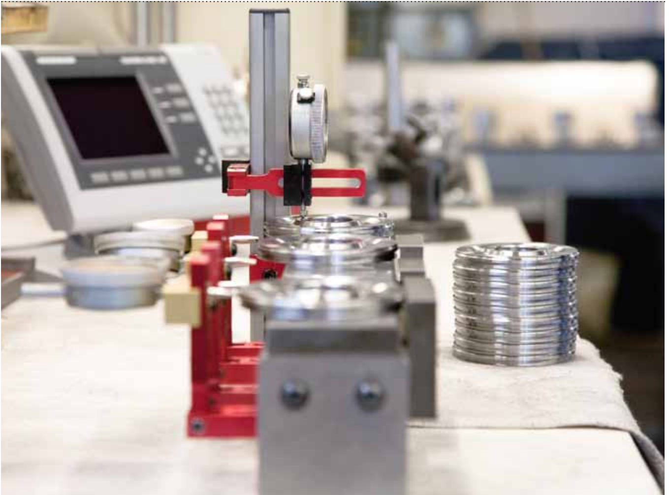
RUNDLAUF-, AUSSENDURCHMESSER- UND BOHRUNGSPRÜFUNG Ausführung Alu, Granit und Stahl siehe Preisliste
